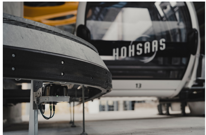
Bild: Sensoren des Überwachungssystems. Copyright: Remo Schnyder
